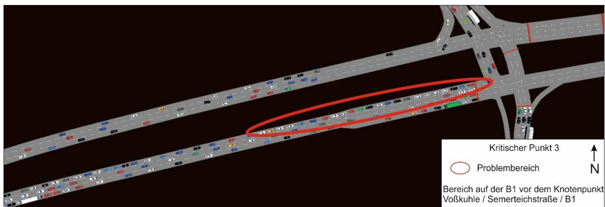
Abbildung 28: Linksabbieger blockieren die linke Spur [Quelle: VISSIM, Eigene Darstellung – Anhang: MSS – Problem 3.jpg]
