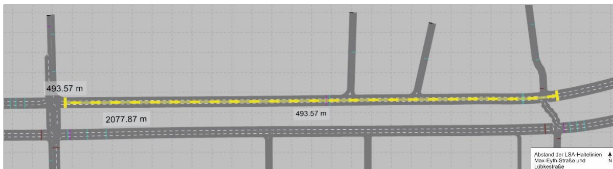
Abbildung 45: Abstand der Haltelinien zwischen der LSA Max-Eyth-Straße und der LSA Lübkestraße [Quelle: Eigene Darstellung aus VISSIM]
